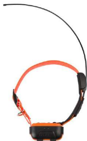
Collier de géolocalisation Canicom GPS 2 équipé d'un module GPS/GALILEO haute sensibilité
